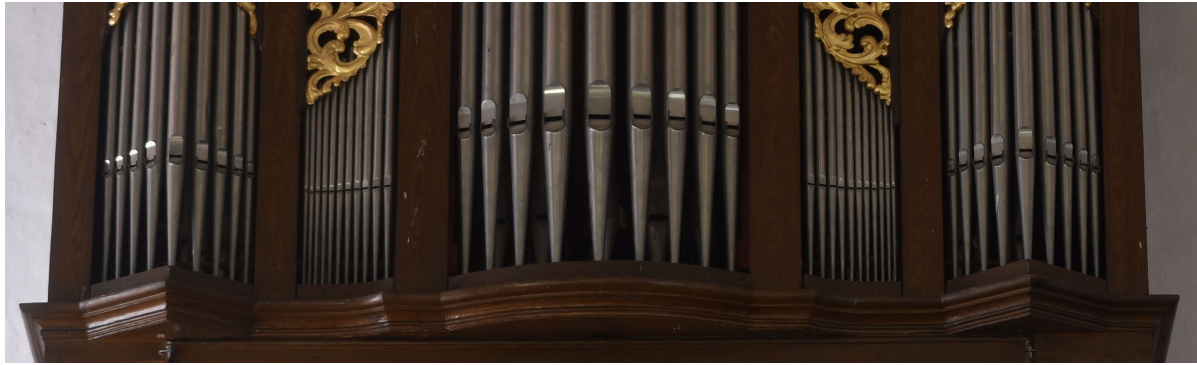
Abbildung 4: Labienverlauf der Prospektpfeifen der Orgel in Mühlheim am Inn, Baujahr 1976 (Eisenbarth, Passau)
