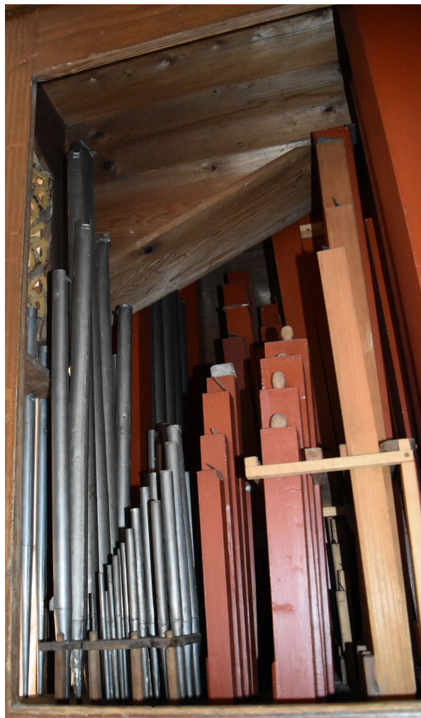
Abbildung 3: Blick ins Manualpfeifenwerk: Unmittelbar hinter dem Prospekt ist die Gambe 8' aufgestellt, dahinter stehen die Mixtur sowie die weiteren Stimmen in der Steigerung der Pfeifenlängen: Octav 2', Quint 3', Flöte 4', Copel 8' und Portun 8' (seit 1921 durch Philomele 8' ersetzt).
